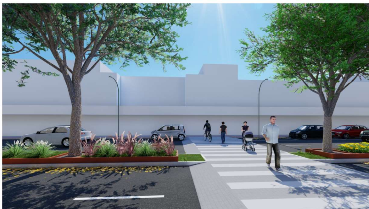
Figura 21 – trecho em detalhe de parte do canteiro central com a adequação da travessia elevada de pedestres (fonte: Serpenge)
