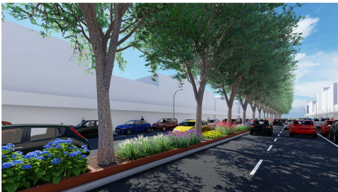
Figura 18 – trecho típico do canteiro com a inserção de novos meios-fios internos, destacado com pintura, e golas de proteção em torno dos troncos das árvores (fonte: Serpenge)
