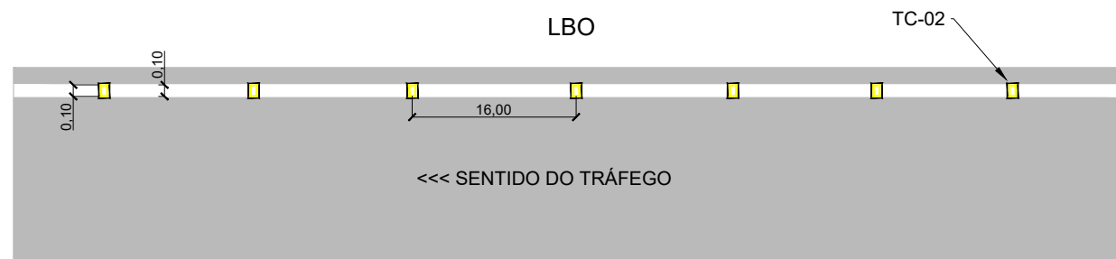
LBO: CADÊNCIA (t:e) CONTÍNUA TACHA TC-02: CADÊNCIA (u:e) 1:16 / ELEMENTO AMARELO VOLTADO PARA O CONTRA-FLUXO
