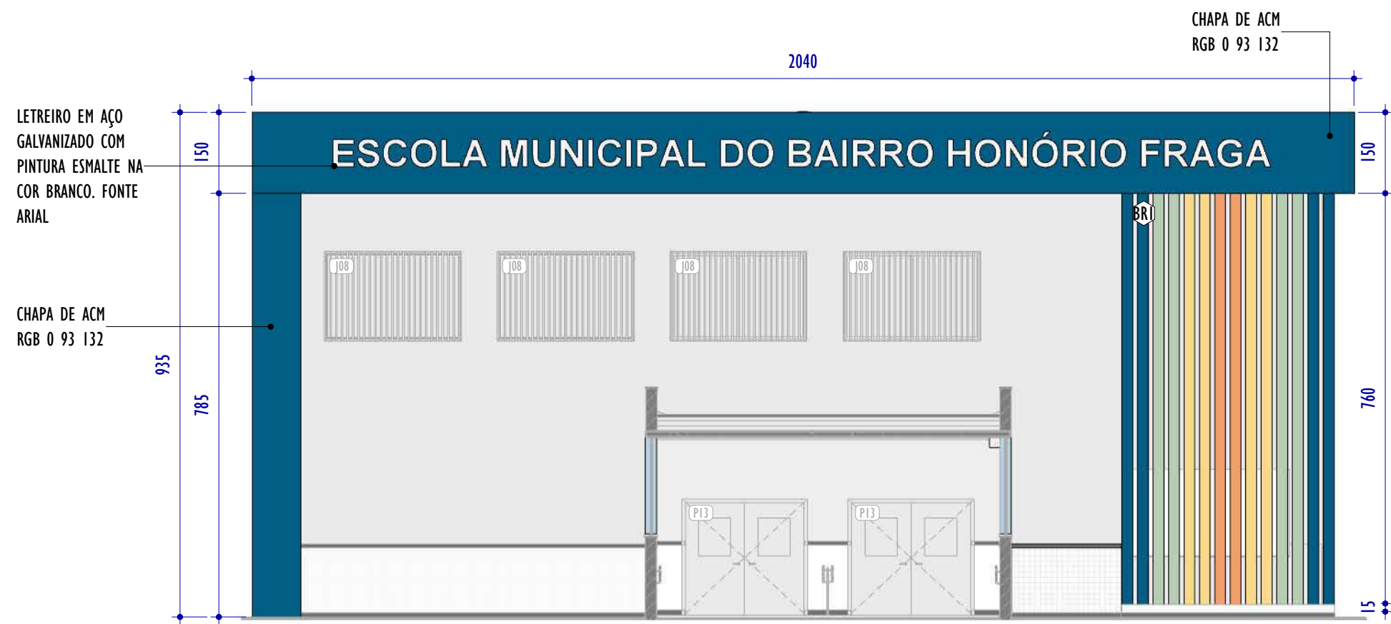
DET. ACM E BRISE - FACHADA FRONTAL
